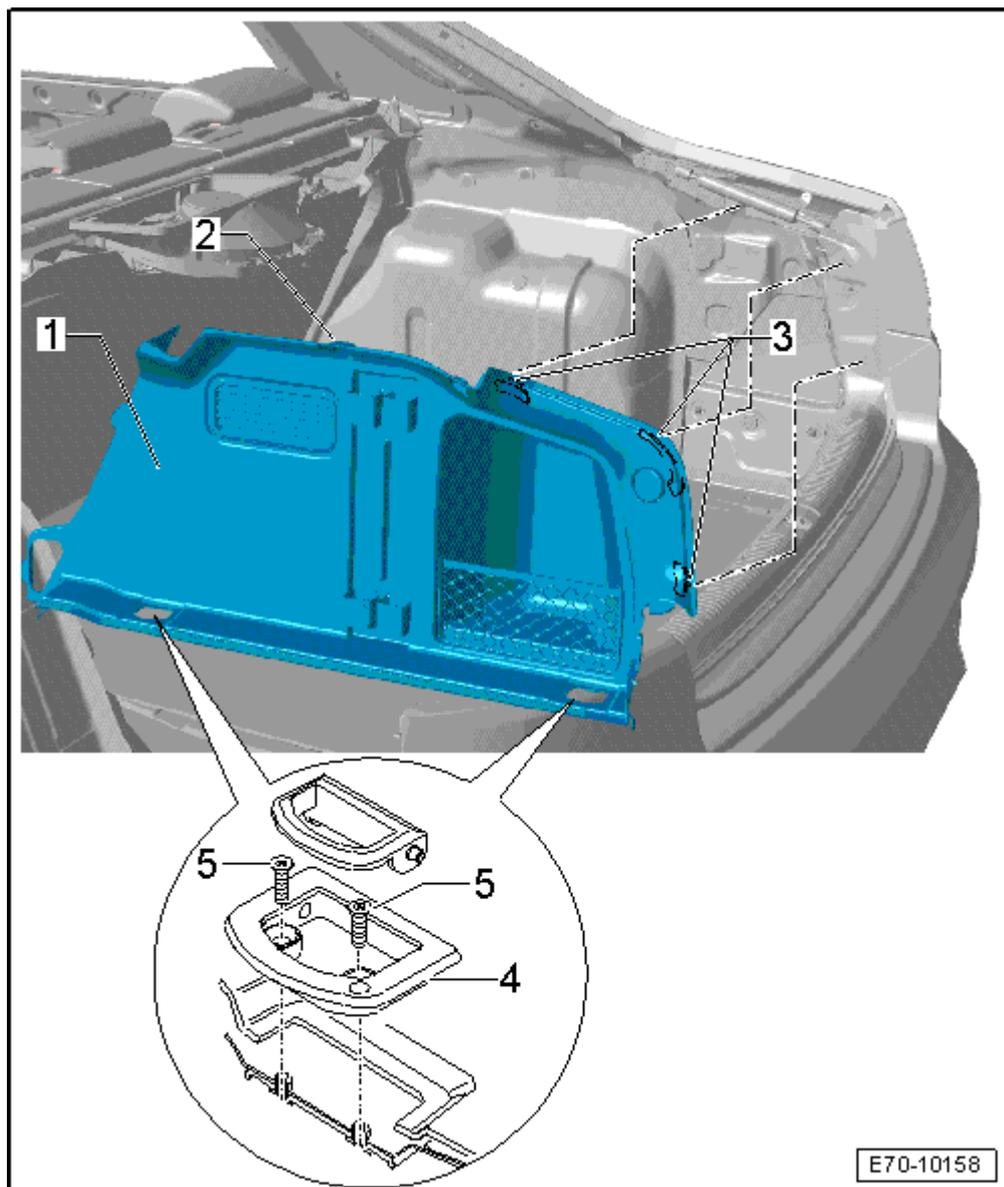
**Revestimiento lateral derecho del maletero: desmontar**
