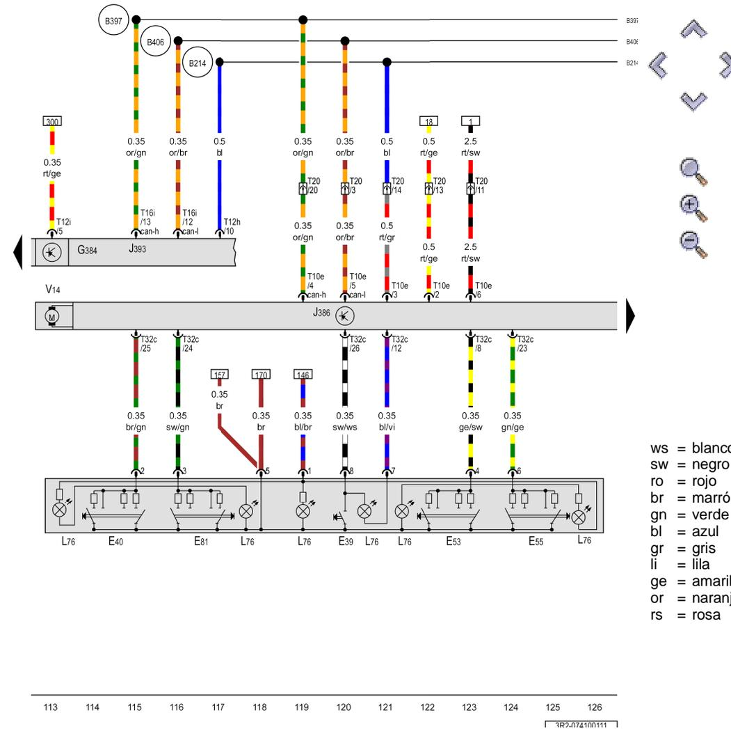
**Conmutador del elevavinas delantero izquierdo, Sensor de la inclinación del vehículo, Unidad de control de la puerta del conductor, Unidad de control central del sistema de confort, Motor del elevavinas izquierdo**
