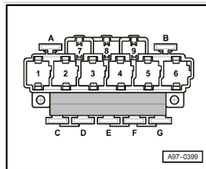
**Dotación de fusibles adicionales (S) en los portafusibles del portarrelés (9 relés)**
