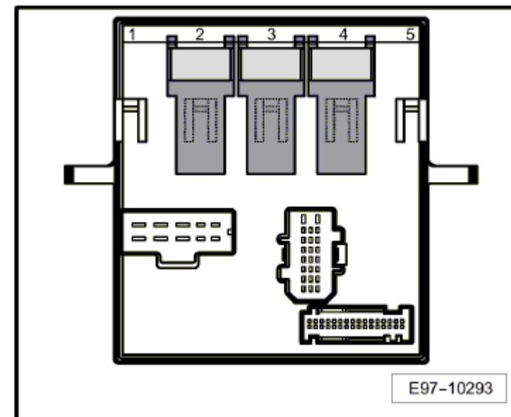
**Dotación de fusibles adicionales (S) en la Unidad de control para red de a bordo -J519-**
