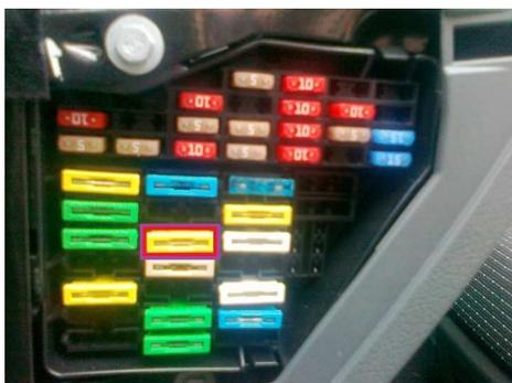
Es el fusible amarillo que esta encuadrado en morado, al estar la caja de fusibles suelta accedéis fácilmente por detrás y ponéis el cable en ese fusible, cerráis todo y ya lo tenéis
