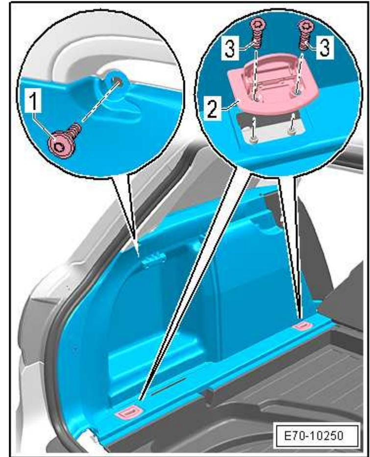
– Desprender el revestimiento lateral -1- con la ayuda de la palanca para revestimientos -T10039-.
