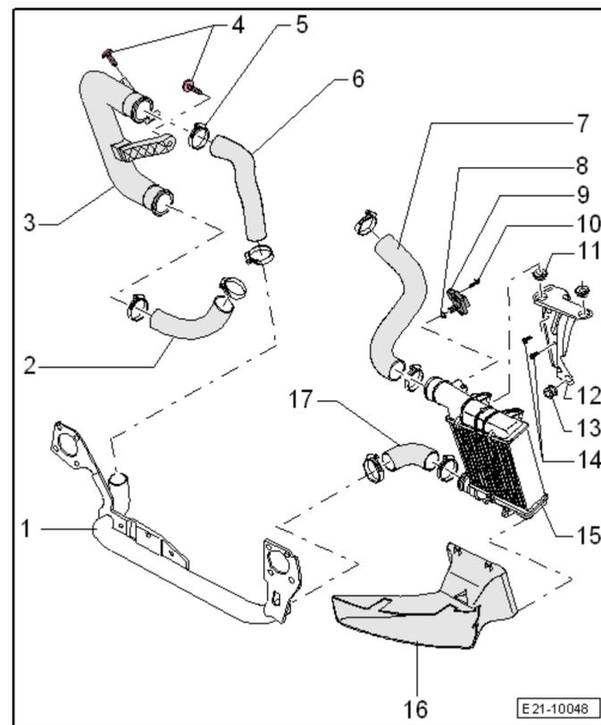
**Montar las conducciones flexibles para aire con abrazaderas de tornillo**
