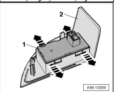
Luz del seguro de la puerta y luz talonera: desmontar y montar
