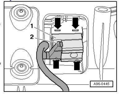
Conmutadores de los elevalunas de la parte trasera -E52-/ -E54-: desmontar y montar
