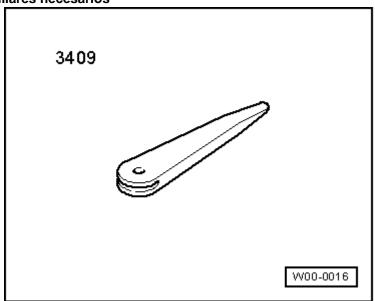
Haciendo palanca con la cuña de desmontaje -3409-, sacar el conmutador -1-
