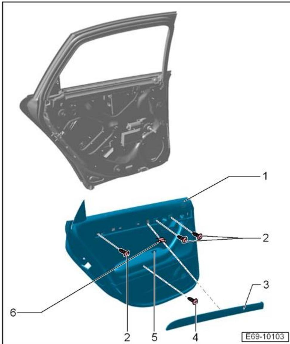
Para el montaje tiene que oprimir por el centro el revestimiento de la puerta contra el cuerpo básico de la puerta.
