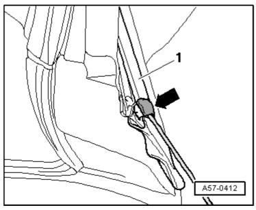
Desprender la moldura del hueco -1- de la pieza de soporte haciendo palanca con una cuña de plástico.
