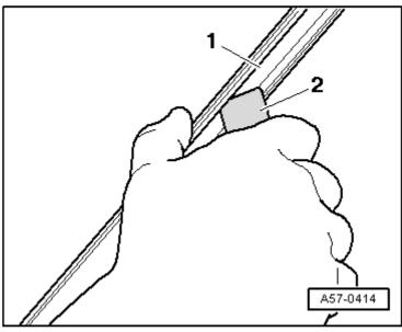
Colocar la moldura del hueco -1- desde arriba y hacer presión a mano y con cuidado sobre la moldura del hueco encajándola por completo en la pieza de soporte.
