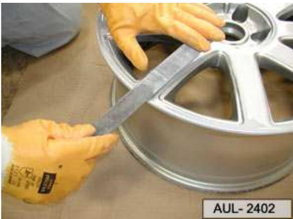
Lijar el área dañada con una lima o una lijadora oscilante. Para eliminar todos los restos de pintura y obtener la profundidad requerida, usar una granulación 120. Los arañazos y las marcas profundas se deben limar y redondear en todos los casos para evitar un efecto de entalladura. El entorno inmediato del área de reparación se debe lijar en profundidad para garantizar la adherencia del material de emplastecido saliente.
