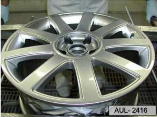
Después se aplican 2 pasadas de pintura transparente de 2 componentes (aprox. 50 $\mu$ m).
