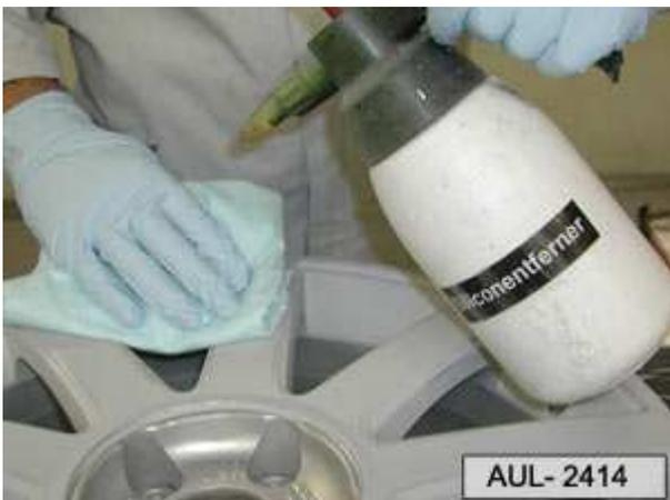
Antes de aplicar la pintura base, limpiar la llanta con eliminador de silicona.
