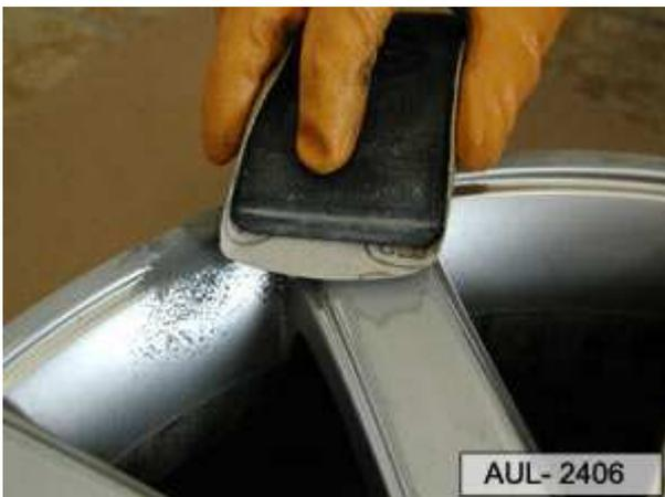
Una vez endurecida la masilla, se lija a mano formando los contornos. Dado que en la reparación de llantas sólo se admite una profundidad de emplastecido de máx. 1 mm, por lo general se puede prescindir del uso de un eyector de infrarrojos.
