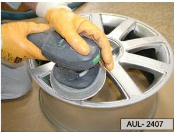
Para conseguir una mejor adherencia de los materiales de reparación, toda la llanta se debe lijar en seco con P400.
