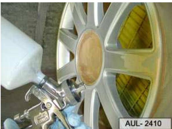
A continuación, imprimir sólo los puntos reparados con el Wash Primer LHV 043 000 A2 de 2 componentes. Hasta la fecha no se admite el uso de otra imprimación.
