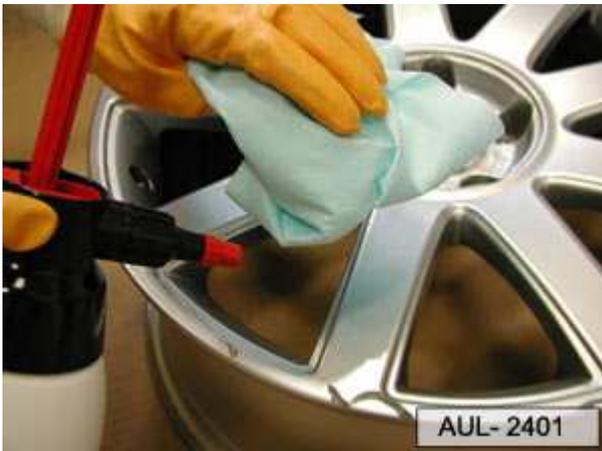
Después de asegurarse mediante el catálogo de muestras límite de que se puede realizar la reparación, limpiar la llanta con eliminador de silicona.
