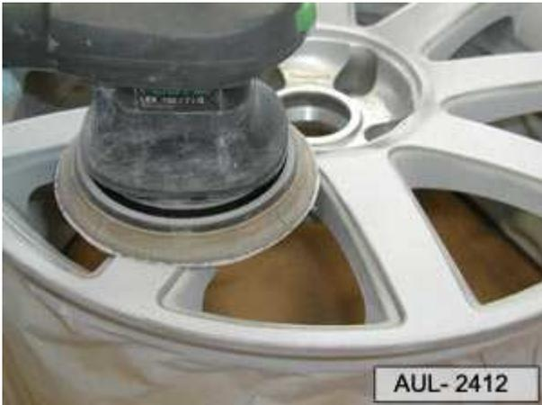
Cerciorarse de que el relleno esté suficientemente seco. Lijar el área de reparación con la lijadora excéntrica de grano P400. Lijar las áreas de difícil acceso con P400 en seco o P800-P1000 en húmedo.
